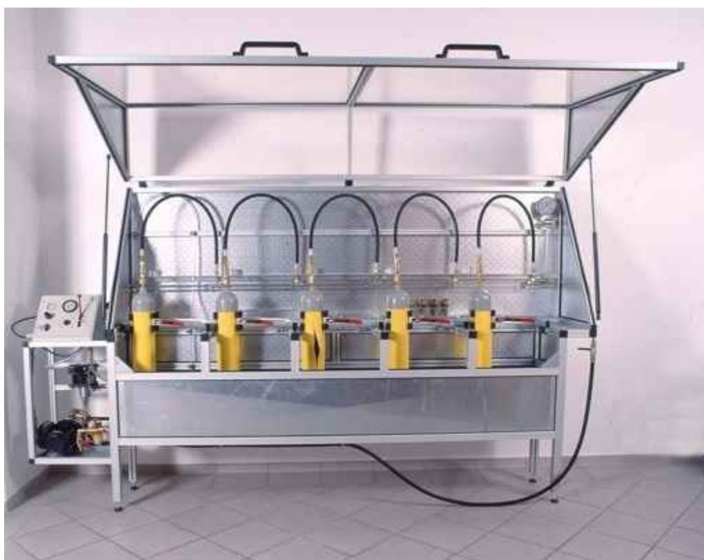
Stacja prób ciśnieniowych zbiorników HTG 500
